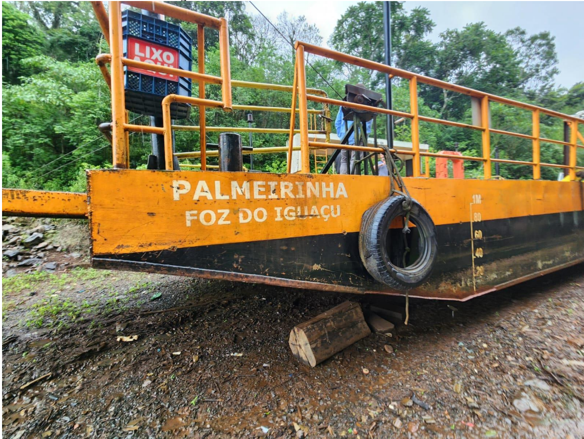
Figura 5 - Calados a vante, a meia nau e a ré.
