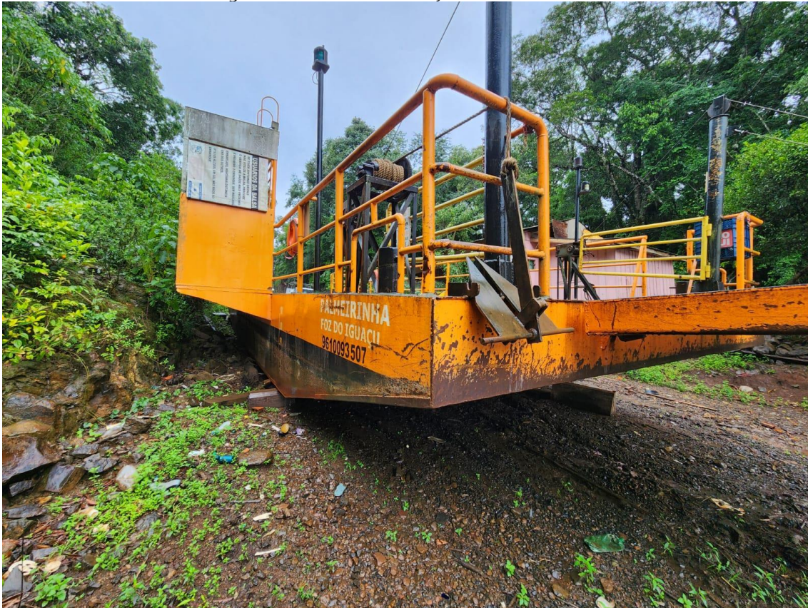
Figura 4 - Nome da embarcação deve ser soldado.
