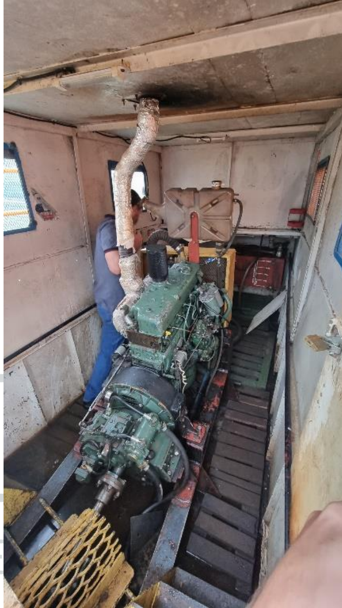
Figura 13 - Necessário a criação de um guarda corpo envolta do MCP.
