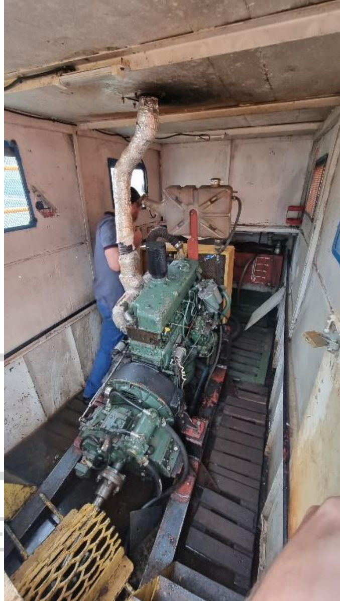
Figura 16 - Necessário a criação de um guarda corpo envolta do MCP.
