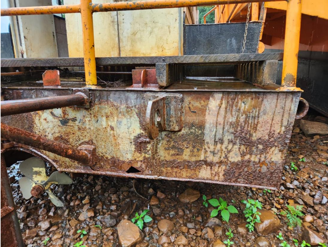
Figura 4 - Espelho de popa possui furo na chapa.
