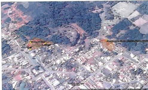
Figura 1. Localização das áreas vistoriadas no perímetro urbano de Cruz Machado. Polígono marrom: limite aproximado da encosta afetada. Linha vermelha: escarpa de deslizamento rotacional.
