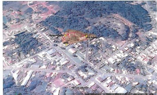
Figura 2. Localização da Área 1. Polígono marrom: limite aproximado da encosta afetada. Linha vermelha: escarpa de deslizamento rotacional.
